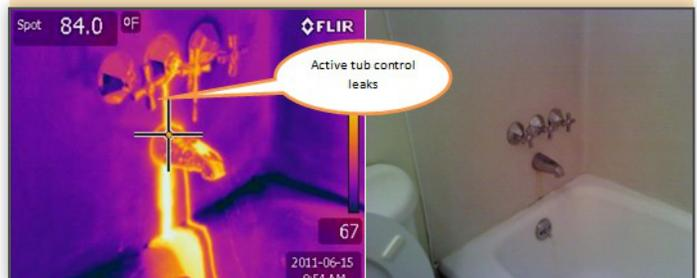
Figure 3: Exemple de détection d'une fuite d'eau
